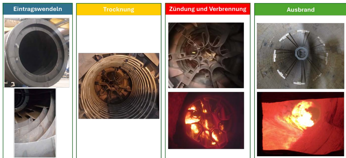
Bild 4: Innerer Aufbau des Drehrohrofens
